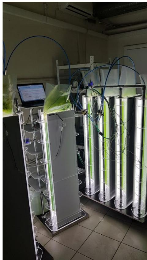
Рис. 2. Функционирующий предпилотный фотобиореактор в ходе культивационного эксперимента.
