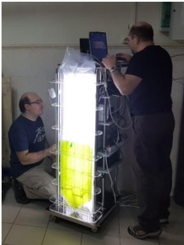
Рис. 1. Первый культивационный модуль предпилотного фотобиореактора с функционирующей автоматикой.
