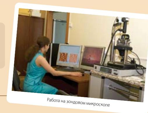
Работа на зондовом микроскопе
