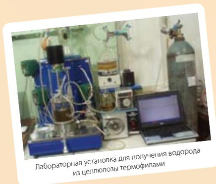
Лабораторная установка для получения водорода из целлюлозы термофилами
